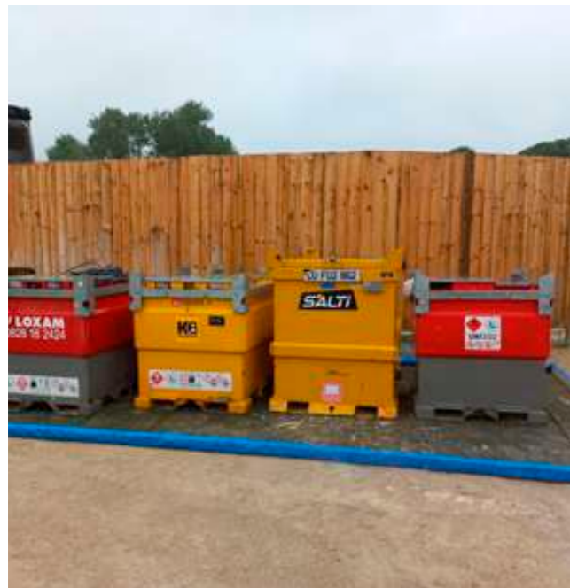
Site du Château de Versailles – Stockage cuve sur bâche – Crédit Paris 2024 (JMA)
